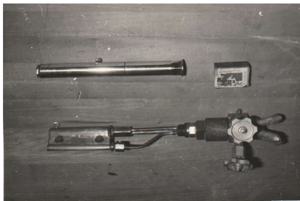
Рис.1. Общий вид экспериментальной установки, выполненной в виде горелки ракетного типа с пористой системой охлаждения.
